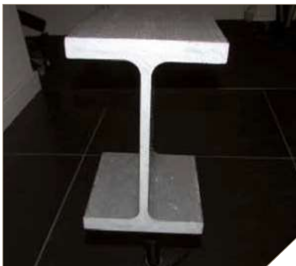
Profielen opgebouwd met basaltvezels en epoxy.
