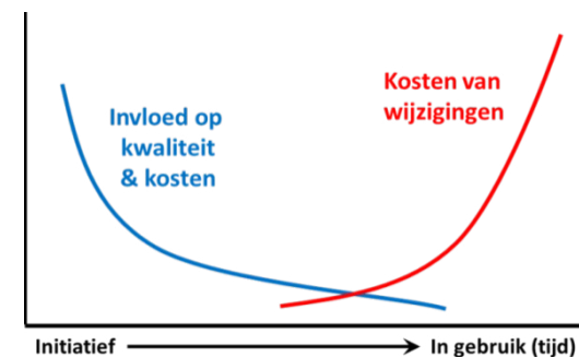
Figuur 12: de relatie tussen kwaliteit, kosten en wijzigingen tijdens de looptijd van een project.
